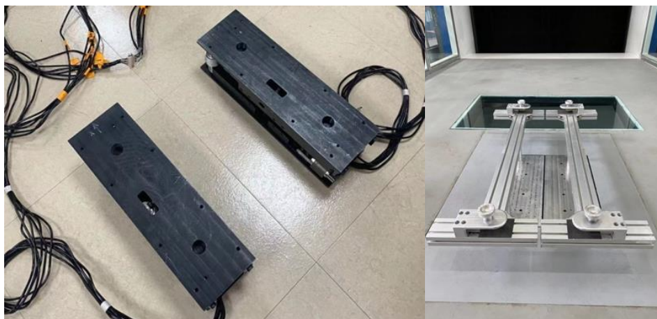
图 2.2 两台单脚测力天平（左）及安装完成后的天平及天平支架（右）
