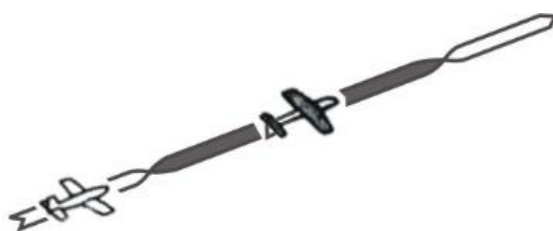
图 I. 12 遥控固定翼模型飞机飞行（四）倒飞直线示意图
