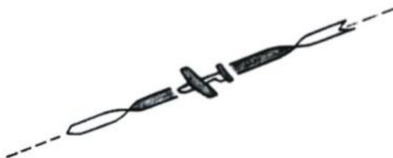
图 J. 10 遥控固定翼模型飞机飞行（五）倒飞直线示意图
