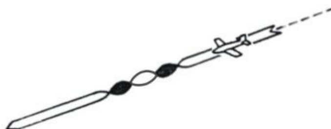
图 J. 12 遥控固定翼模型飞机飞行（五）双向横滚示意图
